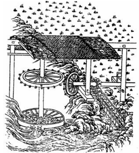
图 4-85 水转翻车 (引自《明》宋应星《天工开物》)
